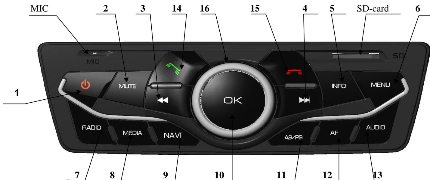
Рисунок 1 – Панель управления ММС
